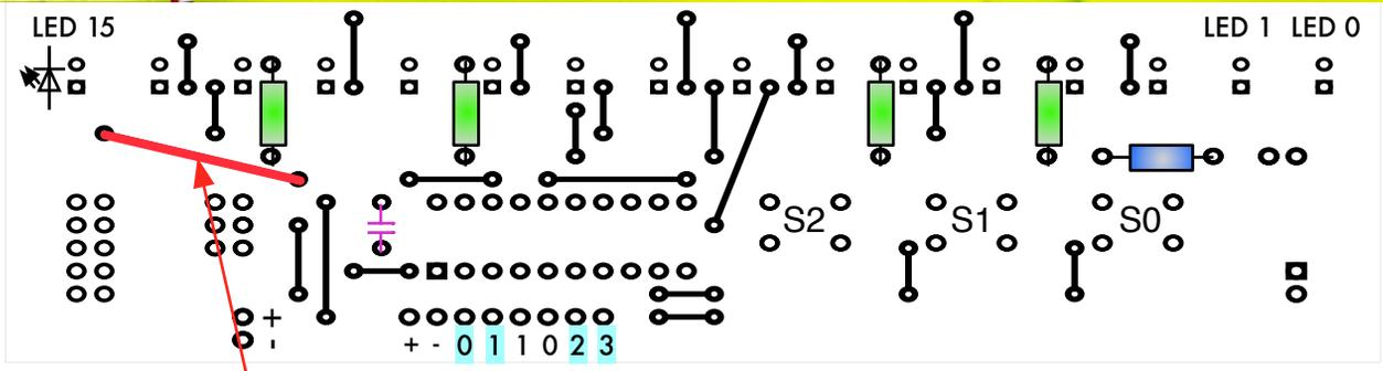
Am Ende als isoliertes Kabel einlöten
